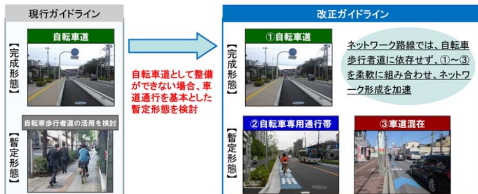
図 1-3 整備形態の柔軟な対応例（完成形態が自転車道の場合）
