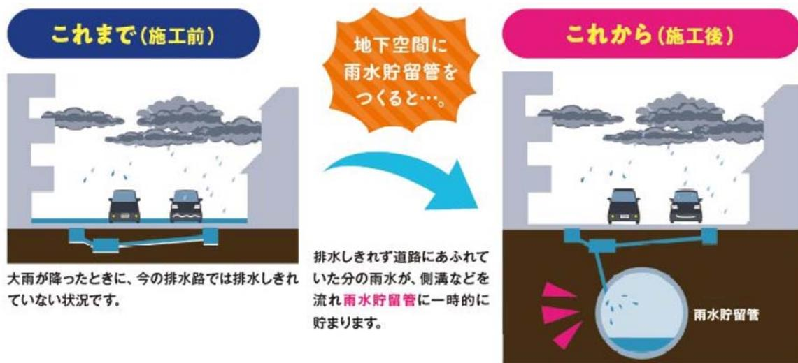
図3-12 雨水貯留管の整備イメージ
