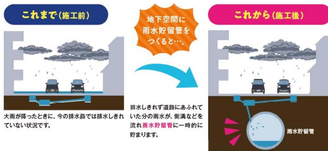
図3-14 雨水貯留管の整備イメージ
