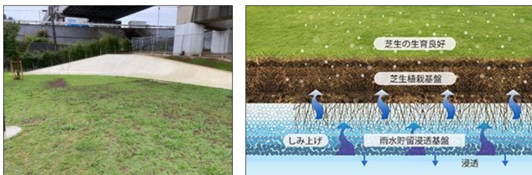
図3-26 芝生広場下の雨水貯留浸透基盤(環境空間戸田1緑地・緑道)
