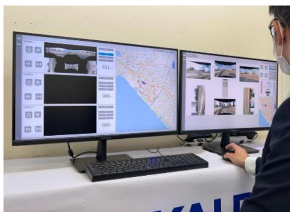
図 【参考事例】深谷市の自動運転バス試乗会と自動運転バス遠隔監視システム
