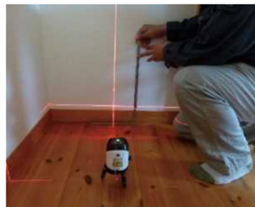
「床の傾きを計測する」調査機器
