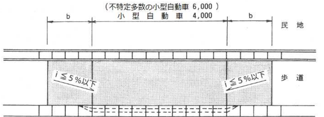
●図-13 小型自動車等の出入口の場合：マウントアップ
