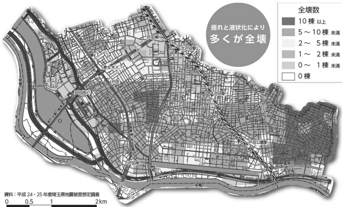
図 3-16 建物倒壊危険度の分布状況
