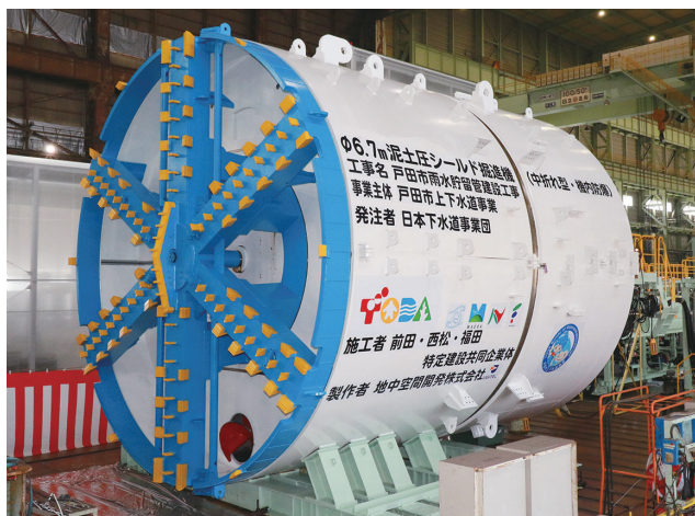
▲完成したシールドマシンの写真
