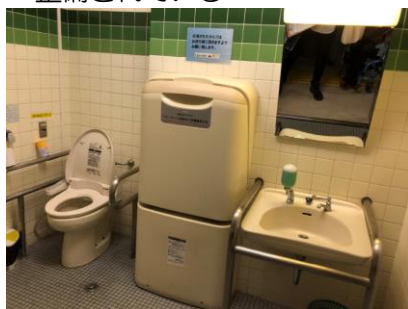
△空間が狭く、ベビーベッドなどで車いすで便器に近づきにくい
