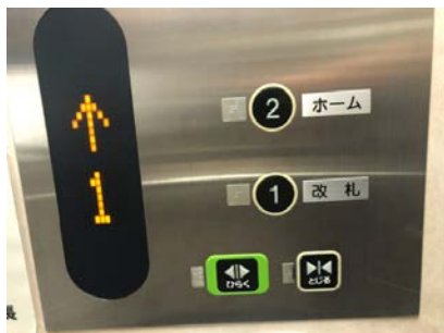
◎浮き出し文字のボタンは点字が読めない視覚障がい者でも認識できる
