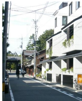
事例39 戸建て住宅の近くに立地する場合は、建物高さや屋根形状を工夫して圧迫感を与えないように努めている。
